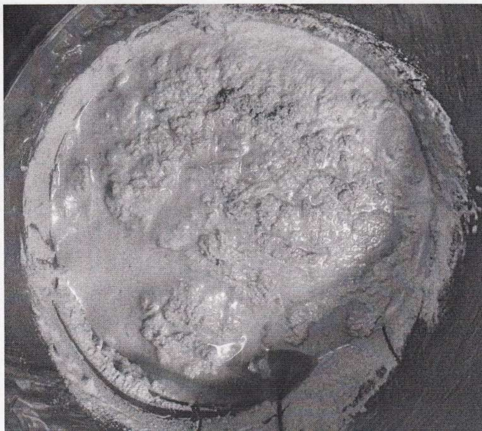
Фото 4. Компонент А после испытаний на морозостойкость
